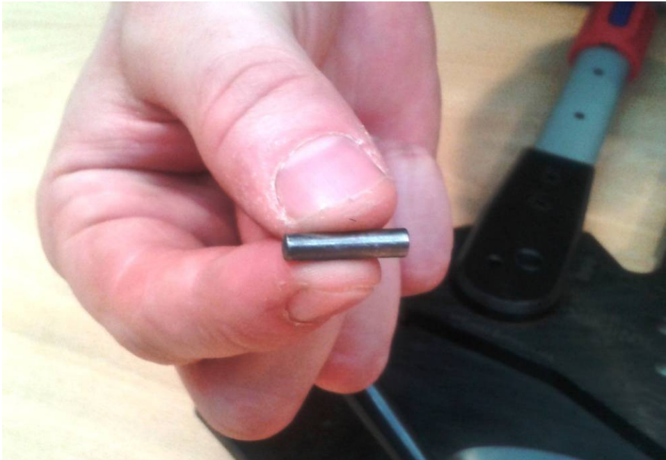
Conical pin Form A 4 x 18 DIN 1
